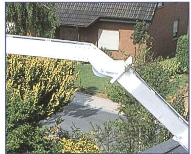
Deux vérins hydrauliques permettant la déclivité du mât avec une parfaite stabilité latérale.
