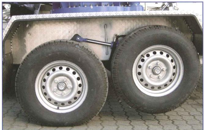
Facilité de manipulation grâce à l'essieu rétractable.
