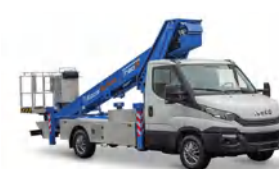
Nacelles sur camion
